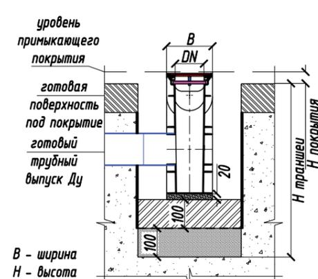
7 Заливка бетонной обоймы сбоку от пескоуловителя. Установка решетки и крепежа обязательна
